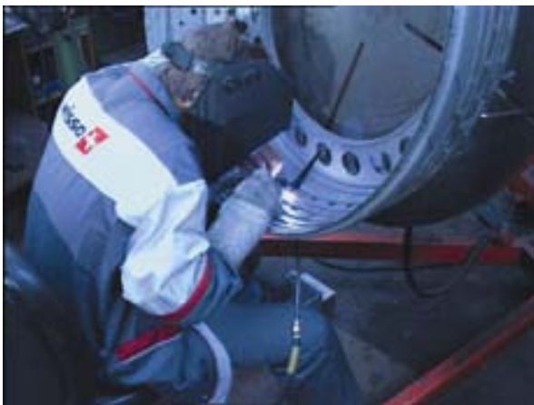
Bild 31 WIG-Schweißen bei der Reparatur von Triebwerksteilen
