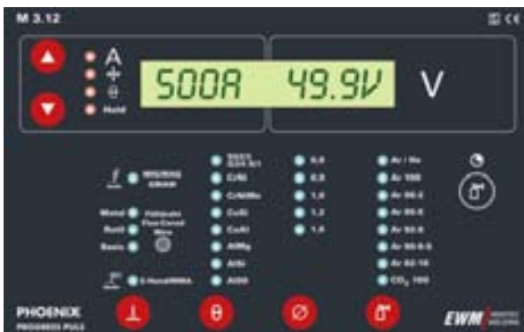
Bild 33 Display des Schweißgerätes PHOENIX PROGRESS
