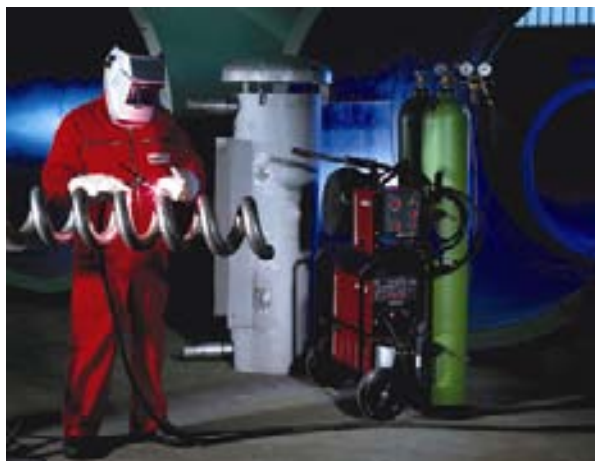
Bild 1 TRITON 260 DC, WIG-Verschweißen von Kühlschlangen
