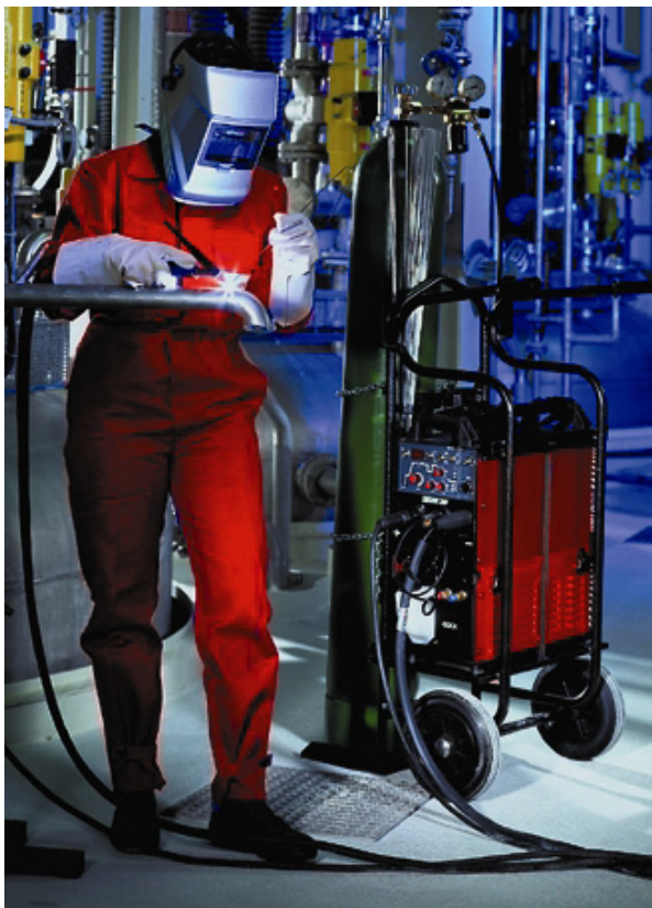
Bild 6 WIG-Schweißerarbeiten in der Chemie-Industrie
