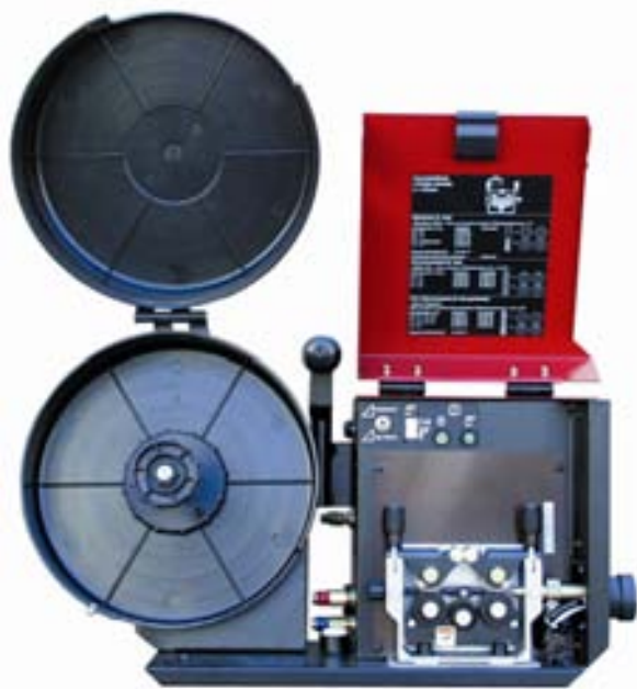
Bild 13 Blick in ein Drahtvorschubgerät mit 4-Rollenantrieb
