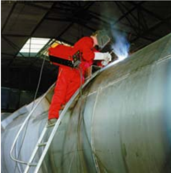
Bild 21 Anwendung des E-Hand-Schweißens im Behälterbau
