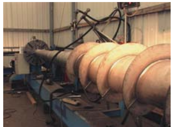
Bild 4 Hartauftragung von Förderschnecken
