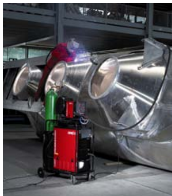
Bild 39 MIG-Aluminium-Schweißen im Fahrzeugbau
