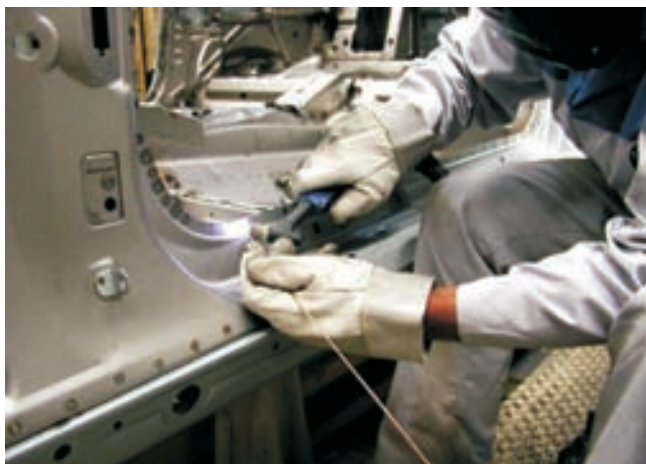
Bild 22: Manuelles Plasmalöten am Türschweller einer BMW-PKW-Karosserie
