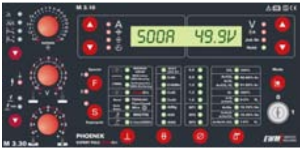
Bild 32 Display des Schweißgerätes PHOENIX 330 EXPERT
