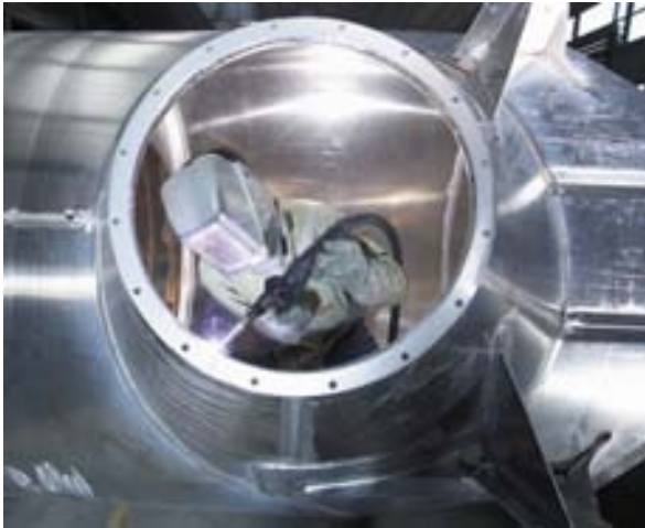
Bild 42 MIG-Schweißen beim Herstellen von Aufliedertanks
