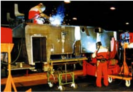
Bild 3 Verschweißen von Feinkornbaustählen im Kranbau
